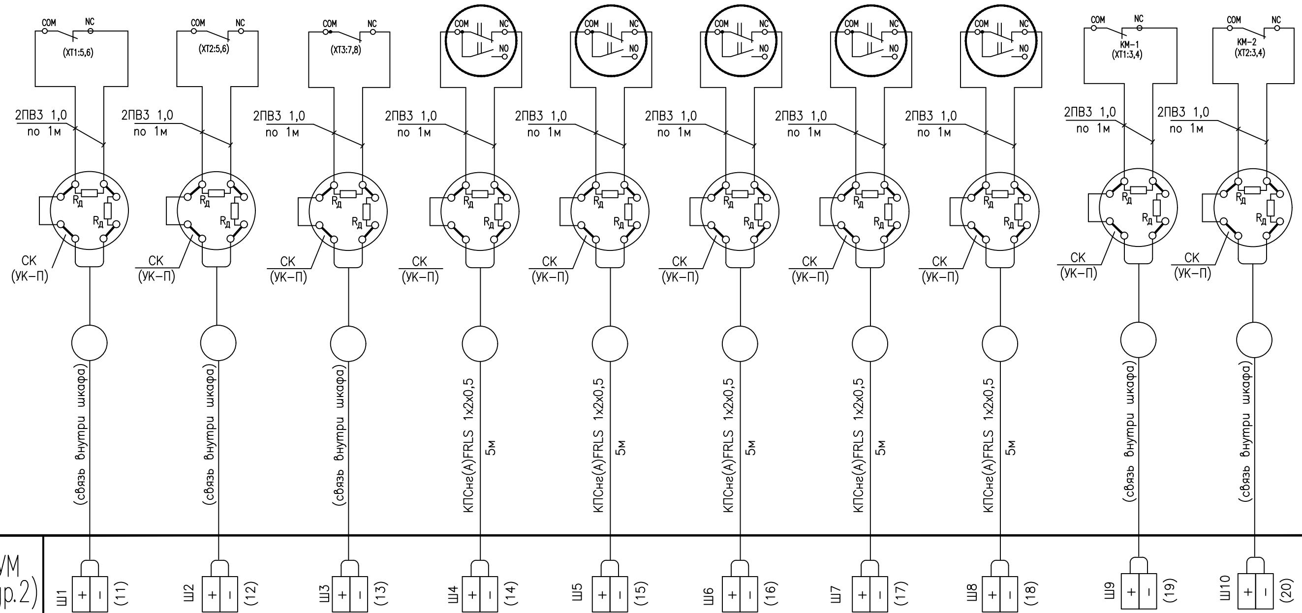
Контроль состояния "норма/авария"      Контроль состояния "норма/авария"      Контроль состояния "норма/авария"      Контроль состояния "норма/авария"      Обобщ.онтр.состояния "закрыто" задвижки/затвора      Обобщ.онтр.состояния "закрыто" задвижки/затвора      Обобщ.онтр.состояния "закрыто" задвижки/затвора      Контроль состояния "закрыто" задвижки/затвора
